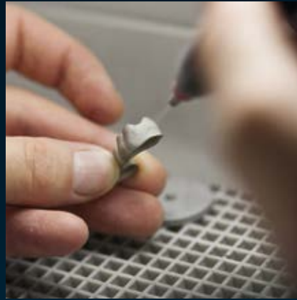
8 Sandstrahlen der Restauration und Vorbereitung für die keramische Verblendung
