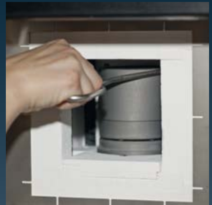
6 Aufsetzen der Sinterretorte und starten des Sinterprozesses
