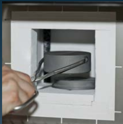
5 Einsetzen der Sinterschale mit aufgesetzter Sinterhaube
