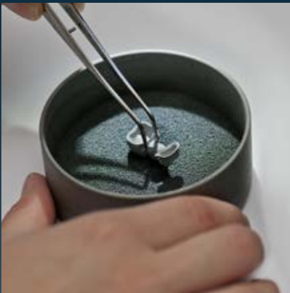
4 Positionierung der Restauration in der Sinterschale des Argovent
