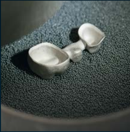
7 Ceramill Sintron® Restauration nach Sinterung und Entnahme aus dem Sinterofen Ceramill Argotherm
