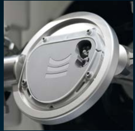
3 Fräsen der Restauration aus dem Ceramill Sintron® Rohling (Trockenbearbeitung in Ceramill Motion 1 oder 2)
